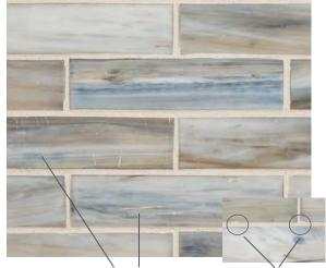
SURFACE FOLDS, SHALLOW CRACKS & CHIPS
